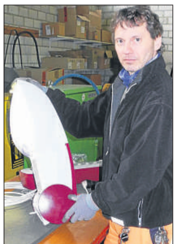
Umrüstung auf LED-Technik: Bauhofmitarbeiter Harald Krug bestückt einen Leuchtenkopf mit einer energieeffizienten LED-Lampe.
